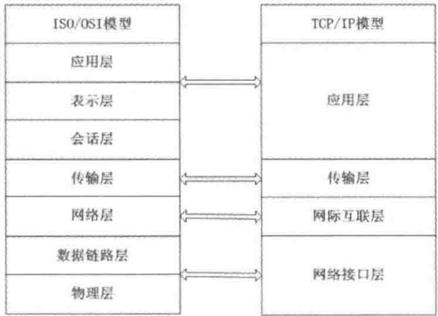
图 3.1 OSI 参考模型与 TCP/IP 协议对比
